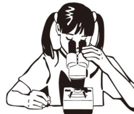
左目でのぞきながら視度調節リングを回してピントを合わせる。
