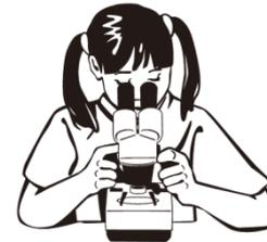
粗動ねじをゆるめ、鏡筒を上下させておよそのピントを合わせる。次に右目でのぞきながら、微動ねじを回してピントを合わせる。
