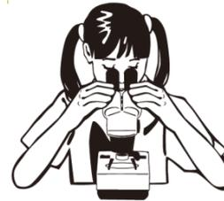
接眼レンズを目の幅に合うように調節し、左右の視野が重なって1つに見えるようにする。
