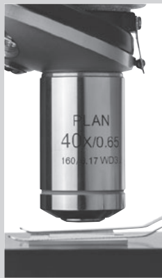
長焦点対物レンズ (作動距離 3.2mm)
