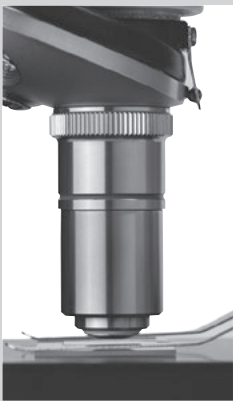
一般的な対物レンズ (作動距離 0.5mm)
