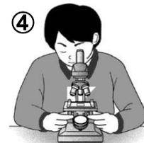
④ 接眼レンズをのぞきながら、調節ねじを③と逆に回して、対物レンズとプレパラートの間をはなしていき、ピントを合わせる。
